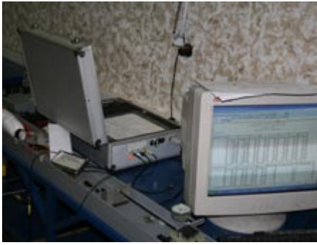
Лабораторный переносной диагностический комплекс (ПДК7) в процессе градуировки датчика деформаций
