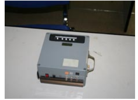
Портативный переносной диагностический комплекс — ПДК4
