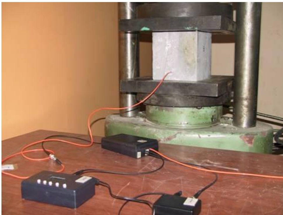
Рис.3 Испытания ВОДД-1 в бетонном кубе, в гидравлическом прессе
